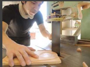
③トリマーで付けたアウトラインにあわせ、帯鋸盤で大まかにカットしていきます。
