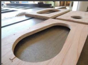
①写真は「治具」という定規のような役目をする道具を用意します。製品のベースになる重要な道具です。
