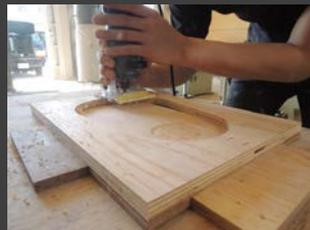
②加工する部材に治具を当て、トリマーという切削機械を治具に沿わせてアウトラインをくり抜きます。
